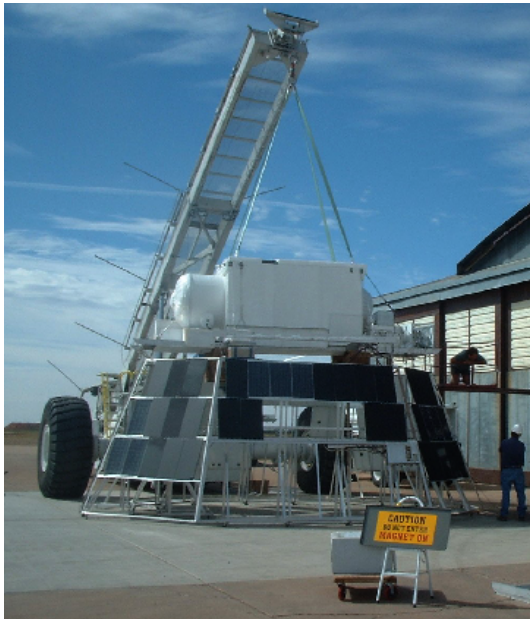
図 7.1 d: 技術試験飛行実験における BESS-Polar スペクトロメータ全景。
