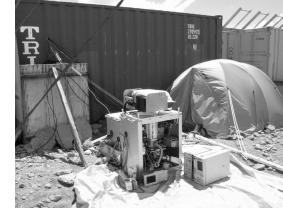
図 4.1 a: アタカマ高地パンパラボラでテスト運用中の可搬型 18cm サブミリ波望遠鏡
