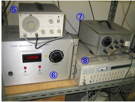
図6 実際の装置。1. オシロスコープ 2. 短波受信機 3. ガン発振器 4. UHF 発振器と周波数カウンタ 5. 変調信号発振器 6. 高電圧電源 7. 矩形波発振器 8. ロックインアンプ 9. 真空計 10. 100 kHz プリアンプ
