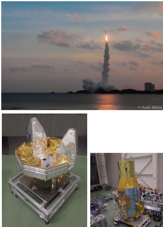
図 7.12: (上)「ひとみ」衛星の打ち上げ。2015年2月17日。(左下) 搭載される硬 X 線イメージャ 2 台。(右下) 打ち上げ前の組み立て中の「ひとみ」衛星。
